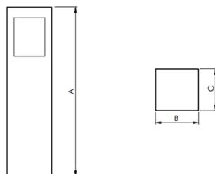
Pétala quadrada, 4W 5000K IRC>80. Corpo em alumínio. Acabamento Branca, Preta ou Especial. Controle óptico principal através de refletor facho assimétrico. Luminária grau de proteção IP-65. Driver corrente constante Liga/Desliga Tensão de trabalho 127V ou 220V.
